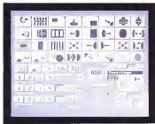
Il Master Control del Video Toaster ci offre un completo banco di regia video. In alto la zona di Preview o Program e l'Quality, a destra si fonda la visualizzazione tra le barre in corso degli effetti programmati e la temporizzazione del rilevante degli stessi. Sono poi presenti le icone degli ambienti software di panning, keying e CG.
